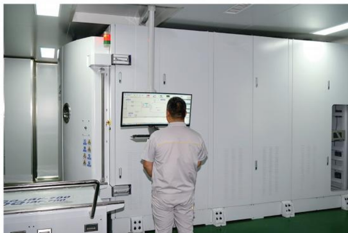
650 мм оборудование обработки ионного пучка
