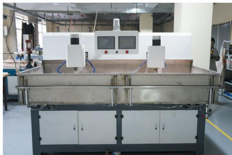
Полировальный станок собственного исследования и разработки для плоскостных оптик
